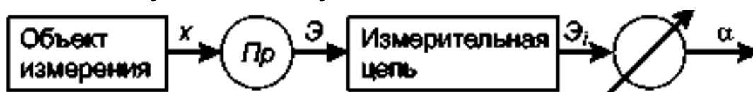
Р и с. 1. Структурная схема метода непосредственного измерения
